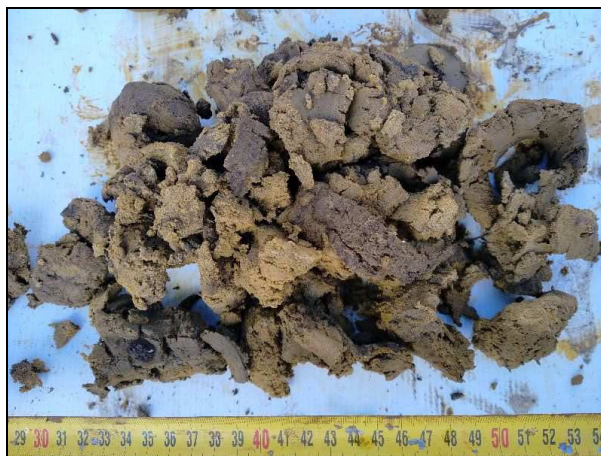
Sol : sable +/- argileux brun vu en T1 de -2,0 m/TN à -3,0 m/TN
